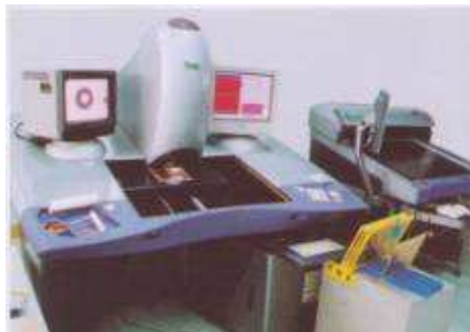
AIO Inner Layer Inspection
